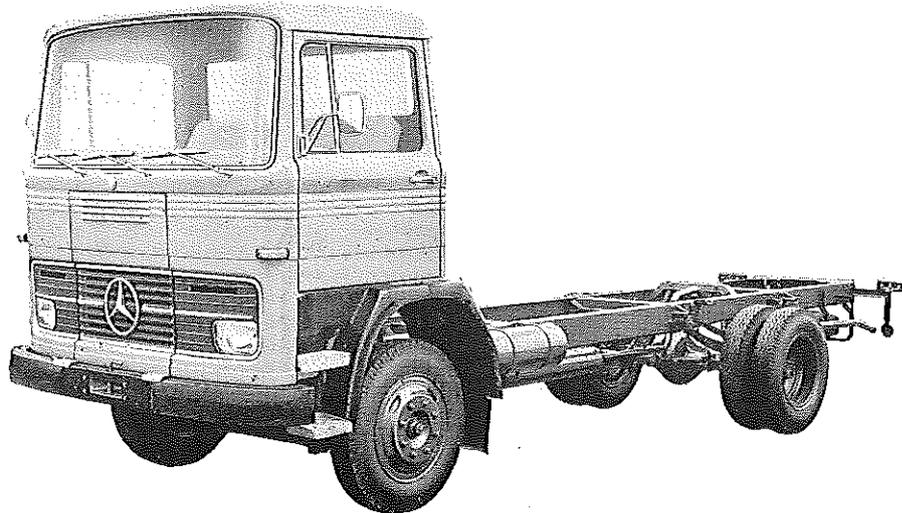
**Diesel-Motor · 6 Zylinder · 4-Takt · 126 PS bei 2800 U/min.**
