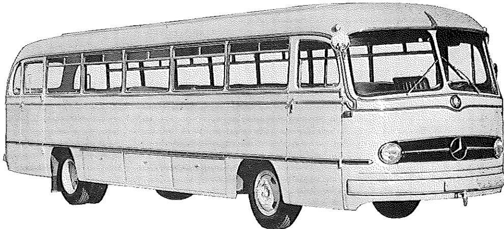
**Diesel-Motor · 6 Zylinder · 4-Takt · 110 PS bei 3000 U/min**
